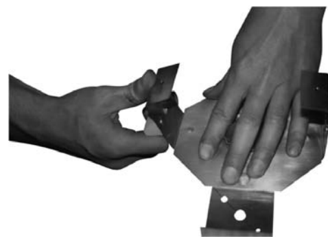
De zijkanten in een rechte hoek naar boven buigen
